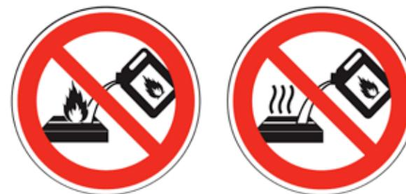
**2.10** Ne pas procéder au remplissage du brûleur quand celui-ci est encore en cours d'utilisation ou encore chaud.
